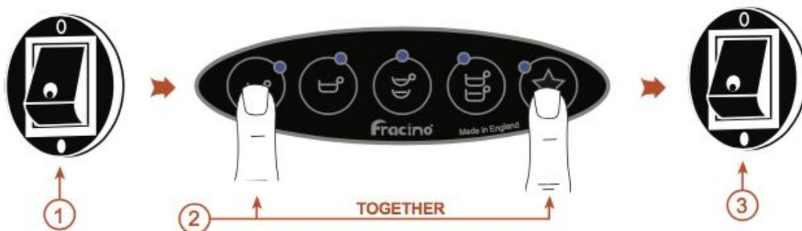
1) Para ingresar a los ajustes técnicos, apague la máquina en el interruptor de encendido / apagado de la red.
